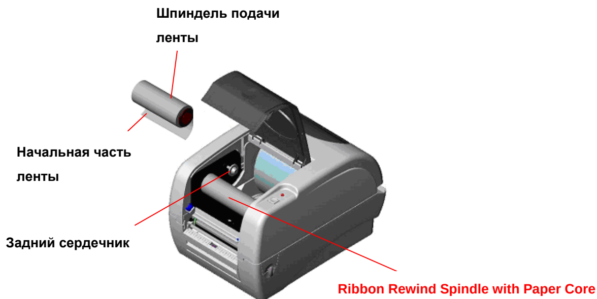
Рис. 5 Установка ленты (II)
