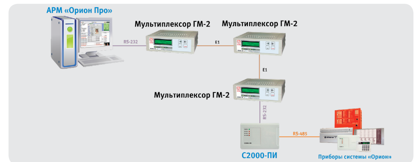
Рисунок 76. Структурная схема использования мультиплексора «ГМ-2» с АРМ «Орион»/«Орион Про» с подключением промежуточного мультиплексора (ремultipлексирование)
