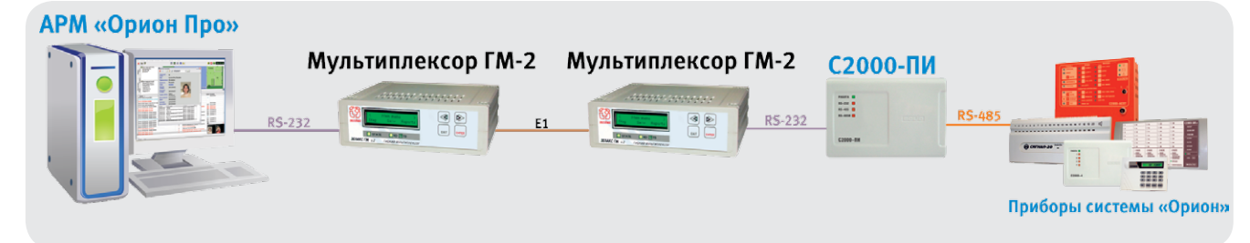
Рисунок 75. Структурная схема использования мультиплексора «ГМ-2» с АРМ «Орион»/«Орион Про»
