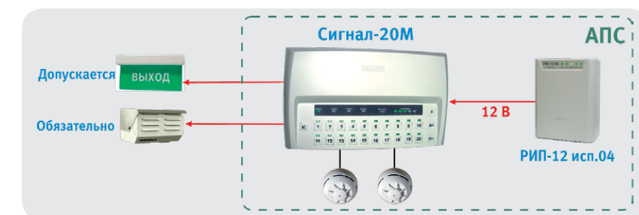
Рисунок 11. Пример СОУЭ 1-го типа на базе блока «Сигнал-20М»
