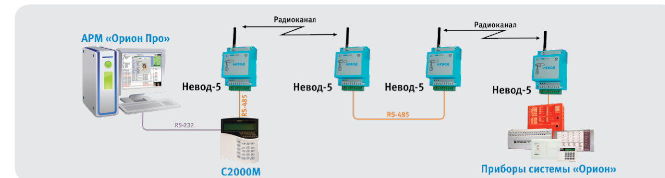
Рисунок 87. Структурная схема использования «Невод-5» с АРМ «Орион» и «C2000М», соединение «точка-точка» с ретрансляцией
