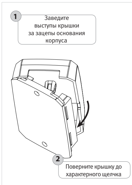
Рисунок 26. Установка крышки прибора
