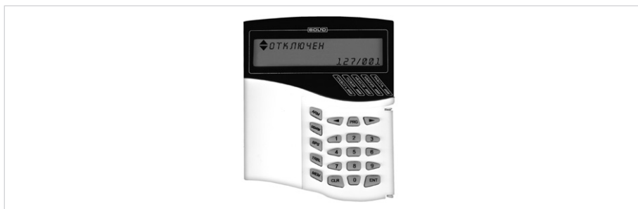
Рисунок 2. Индикатор пульта «С2000М» с соответствующим сообщением
