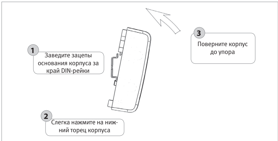
Рисунок 23. Порядок установки прибора на DIN-рейку
