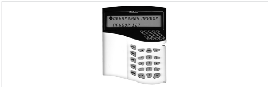
Рисунок 1. Индикатор пульта «С2000М» с соответствующим сообщением
