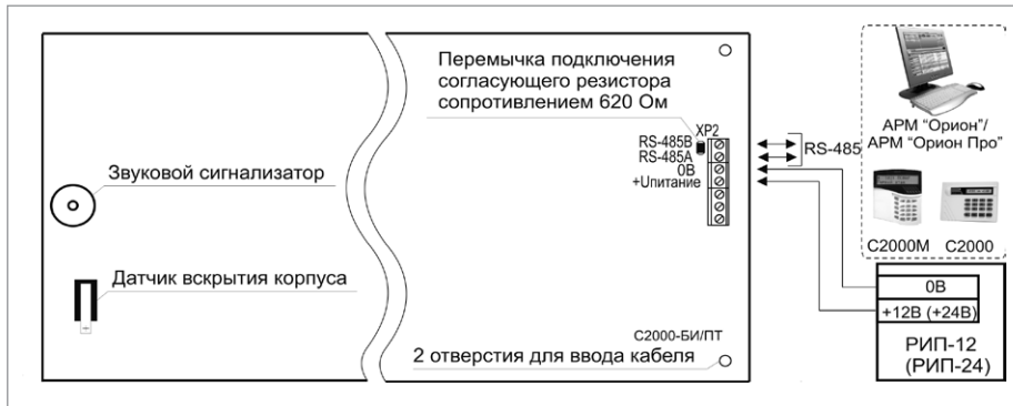
Рисунок 1. Схема внешних соединений блока «С2000-БИ SMD»
