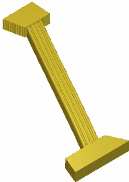
Avant de calculer la forme extrudée, le bloc en haut et en bas de la forme de harpe ont été créés en appliquant un profil plat avec une hauteur peu profonde vers la couleur bitmap rouge en utilisant le **Modificateur de forme**.
