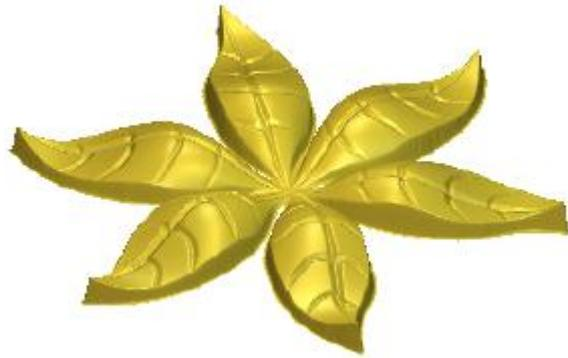
L'ondulation dans la révolution normale est le résultat du profil de modulation des hauteurs en z. La hauteur totale des feuilles est atteinte en redémarrant le relief en dehors de la zone de travail Bitmap en forme de feuille à zéro.
