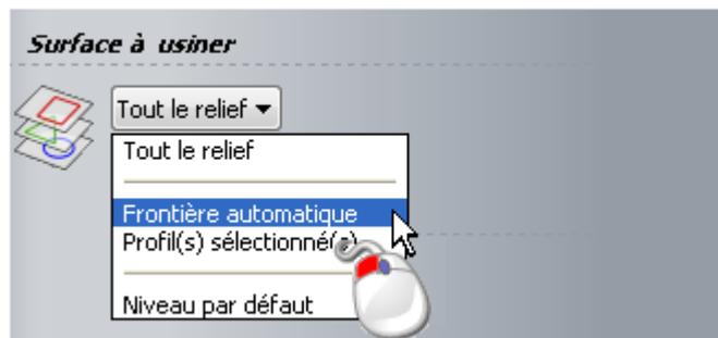
un profil de limite est calculé depuis la géométrie de l'outil et est dessiné sur le calque de profil (voir "Choisir le calque actif" Sur la page 139) actuellement actif.
